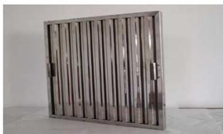
Bestehend aus Rahmen und versetzt angeordneten Halbschalen aus Edelstahl 1.4301, Oberfläche spiegelnd hochglanzpoliert. Die Abscheider sind an den Rahmenecken mit Ablauflöchern versehen.
