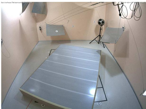
**Bewerteter Schallabsorptionsgrad  $\alpha_w$  nach DIN EN ISO 11654**
